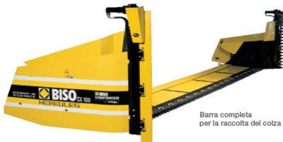
Estensione in avanti della barra di taglio per minimizzare le perdite
