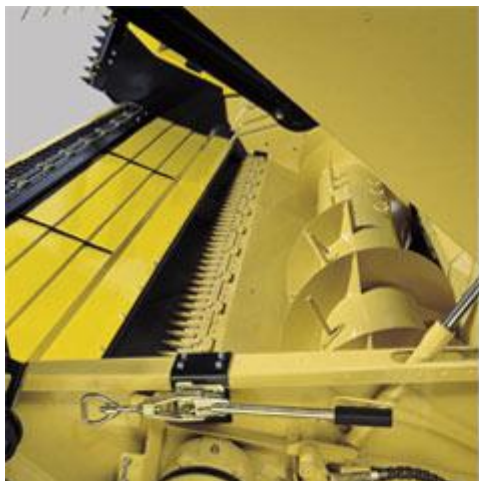
Estensione in avanti della barra di taglio per minimizzare le perdite
